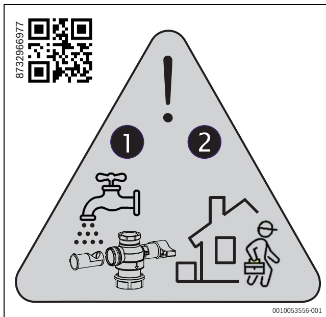
Afb. 56 Deeltjesfilter na onderhoud reinigen
