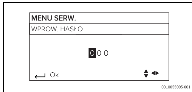
Rys. 52 Wprowadzanie hasła do menu serwisowego
