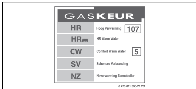
Afb. 14 Gaskeur CW/HRww: 2003, Toepassingsklasse 5
