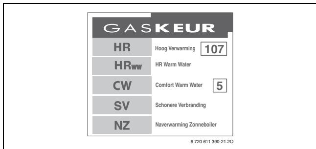
Afb. 13 Gaskeur CW/HRww: 2003, Toepassingsklasse 5
