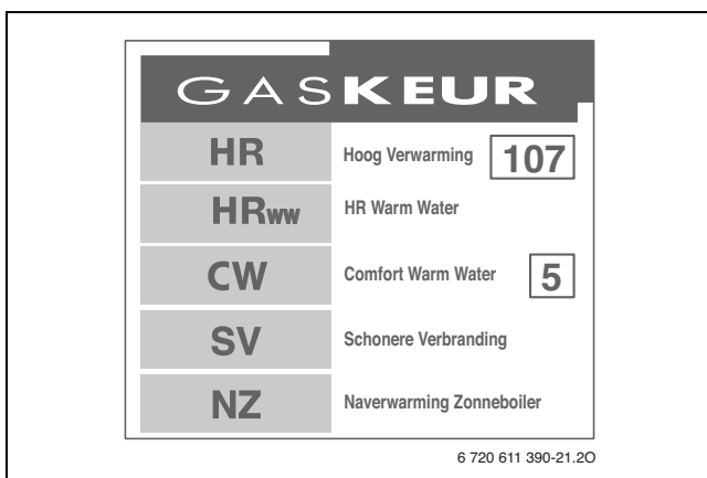
Afb. 12 Gaskeur CW/HRww: 2003, Toepassingsklasse 5
