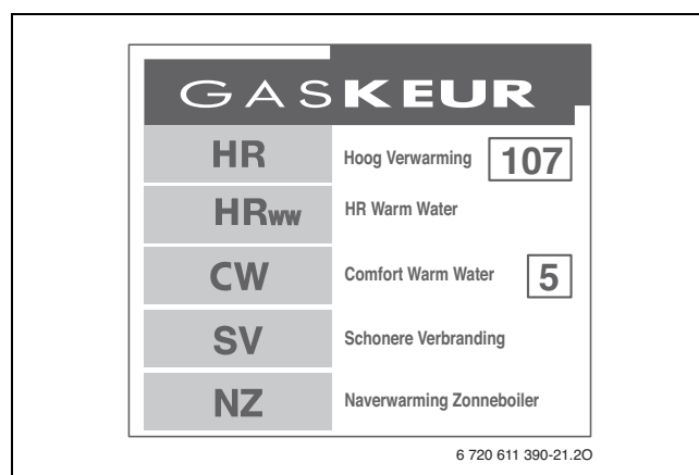
Afb. 11 Gaskeur CW/HRww: 2003, Toepassingsklasse 5
