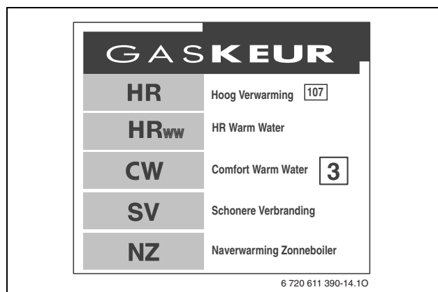
Afb. 9 Gaskeur CW/HRww: 2003, Toepassingsklasse 3
